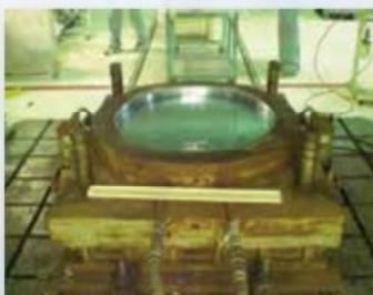
フタ用金型：材料（SMC）投入前
