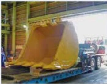
↑巾・高さ・奥行が約3m、重さ約12tの超大型バケット。
