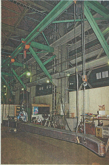
大型建機部品を専用クレーンでつり上げて溶接している工場。受注増をにらみ、生産能力を倍増させる
